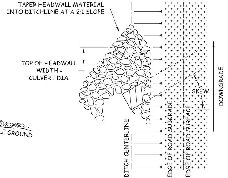
**PLASTIC CULVERT INSTALLATION WITH PLASTIC DOWNSPOUT**
